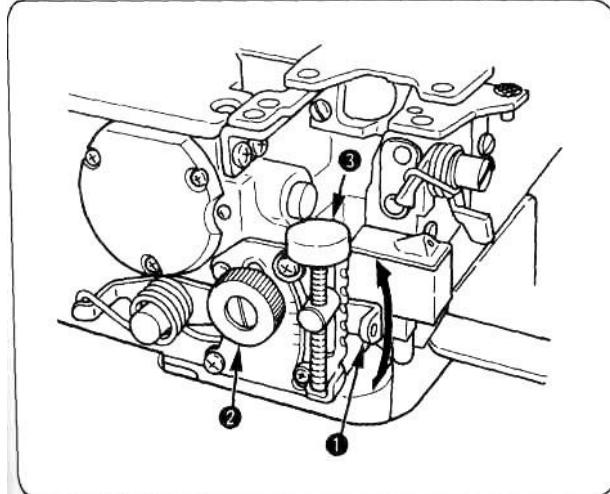
1. Отпустите контргайку дифференциального двигателя ткани 2. Поднимите рычаг 1 вверх (для растягивающего стежка) или опустите вниз (для стягивающего стежка).
