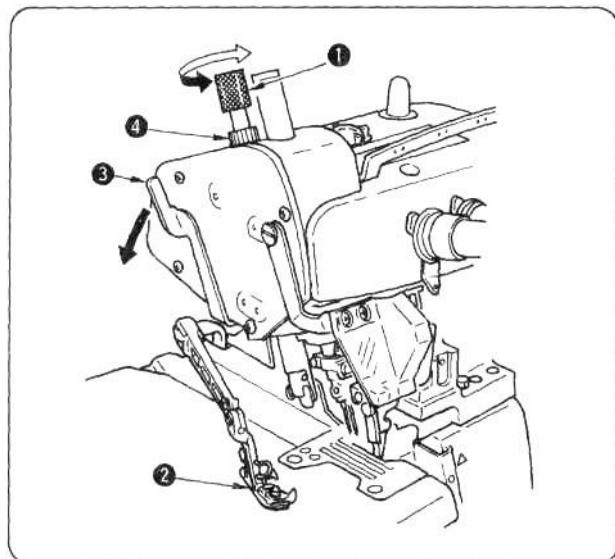
1. Отрегулируйте давление прижимной лапки, отпустив первую гайку 4 и повернув регулировочный винт 1. Если вы повернете его по часовой стрелке, давление увеличится, против часовой стрелки – уменьшится. По завершении регулировки обязательно поверните гайку 4
