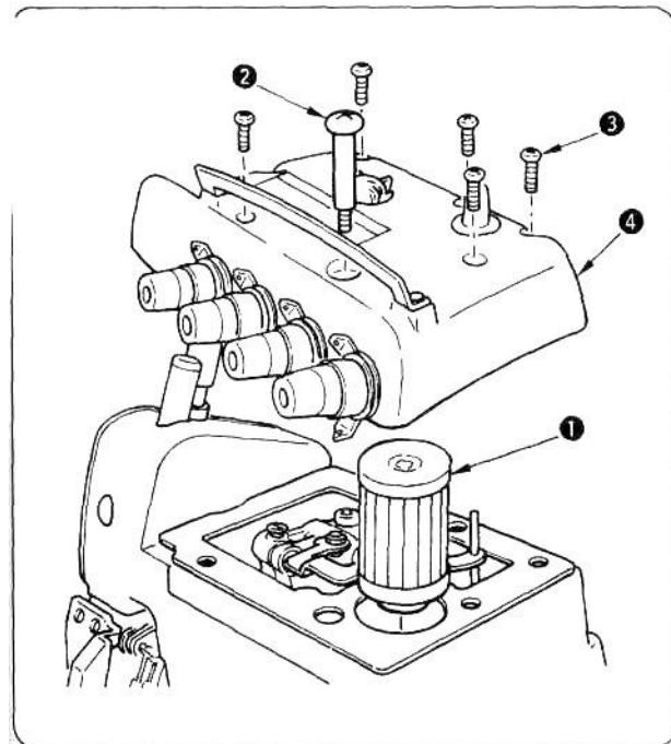
1. После длительной эксплуатации патронный фильтр 1 может засориться пылью. Если оставить машину в этом состоянии, может создаться ситуация, при которой загрязненная смазка не пройдет через фильтр 1, повысится износ машины и устройство заклинит.
