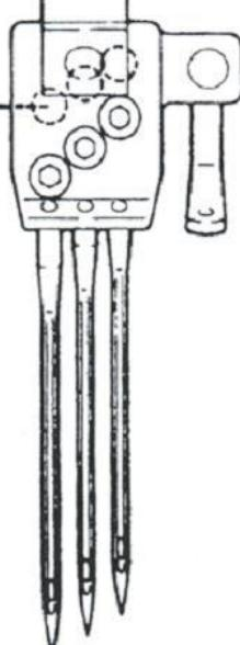
Тщательно проверьте иглу и убедитесь, что паз обращён к задней части машины.
