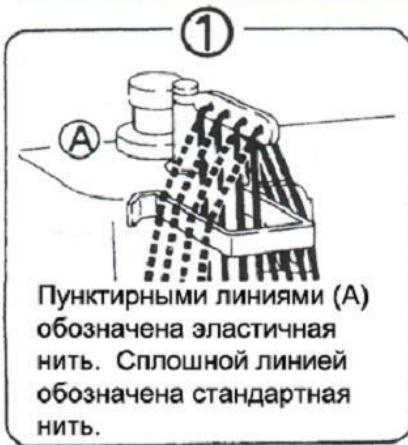
Пунктирными линиями (A) обозначена эластичная нить. Сплошной линией обозначена стандартная нить.
