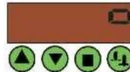
иголки. Знак означает, что ограничитель иглы поднят. В случае, если интерфейс отображает “--” это означает, что система установлена не в режиме ограничителя иголки. Этот параметр можно изменить при помощи кнопок под интерфейсом установки параметров.
