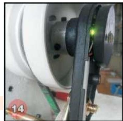
Шаг VI: В случае, если светодиодный индикатор не горит, отрегулируйте фиксированное положение детали 4 и 6 (рис. 15).
