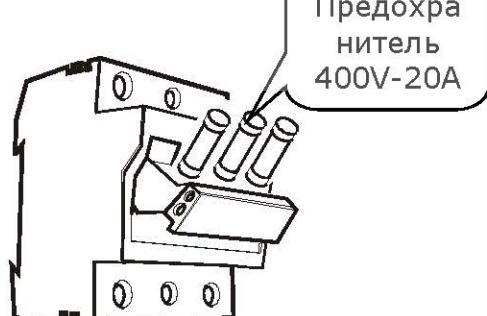
Предохранители защищают парогенератор. Для доступа к предохранителям необходимо повернуть главный выключатель в положение 0 и снять синюю панель.
