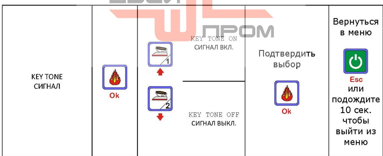
Кнопкой KEY TONE можно включить/выключить звуковой сигнал при нажатии кнопок.
